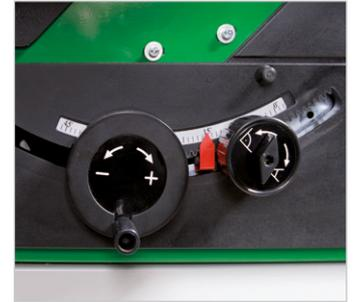
Präzise und leichtgängige Höhen- und Schrägverstellung des Sägeaggregats an einfach bedienbaren Handrädern
