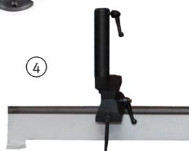
Massive Stahlkonstruktion nur für Handdrechselbänke mit drehbarem Spindelstock.
