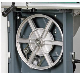
Die 2-stufige Geschwindigkeitsverstellung erfolgt manuell durch Umlegen des Riemens. Diese sind ausgestattet mit Spänebürsten für saubere Laufflächen der Antriebsräder.
