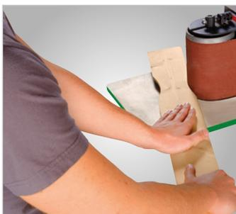
Durch das stufenlos schrägverstellbare Schleifaggregat ist die Kantenschleifmaschine für verschiedenste Schleifvorgänge wie z. B. vertikales und horizontales Schleifen verwendbar
