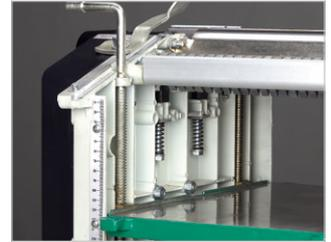
Die durch Federn gelagerten Einzugswalzen verhindern Eindrücke auf dem Holz. Der Dickentisch wird auf vier Säulen geführt.
