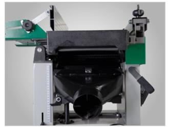
Der integrierte Absauganschluss sorgt für freie Sicht beim Abrichten/Hobeln
