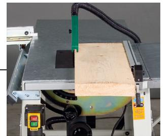
Der Parallelanschlag ermöglicht das Besäumen von Brettern, Auftrennschnitte, Fasen- und Winkelschnitte
