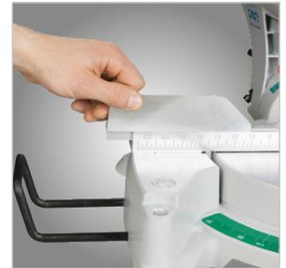
Ausziehbare Anlageschienen rechts und links
