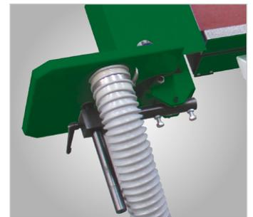
Höhenverstellbarer Zusatztisch mit Absaugung, zum Schleifen von Radien
