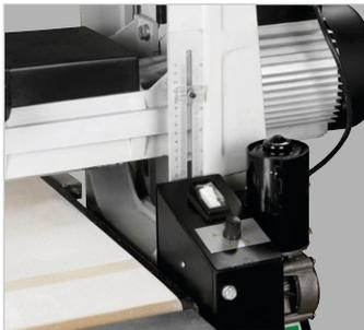
Höhenverstellung der Schleifeinheit an einer Skala ablesbar
