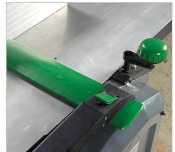
Die Hobelmesser sind durch einen Schutz mit praktischem Schnellspanner abgedeckt. An einer Handkurbel kann die gewünschte Späneabnahme für das Dickenhobeln bis zu 2 mm einfach eingestellt werden. Sie ist an einer Skala bequem ablesbar (Abb. zeigt ADH 250).
