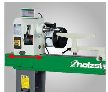
Der Spindelkasten der DB 1100 kann zusätzlich seitlich verschoben und an jeder Stelle des Drechselbettes arretiert werden.
