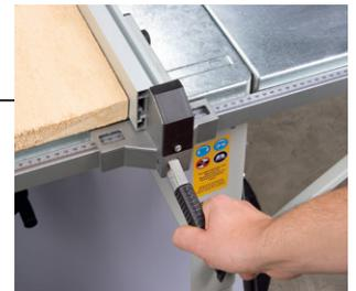
Der Parallelanschlag mit Exzenter-Schnellspannung kann per Skala präzise und leicht eingestellt werden.
