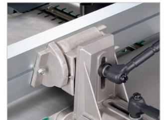
Der Aluminium-Abrichtanschlag ist um 45° neigbar. Die eingestellte Neigung ist bequem an einer Skala ablesbar.
