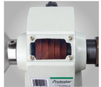
Keilriemen kann über Spannhebel einfach umgelegt und die gewünschte Drehzahl durch ein Sichtfenster kontrolliert werden
