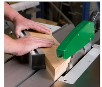
Der Ablänganschlag ermöglicht Gehrungsschnitte beidseitig 45°
