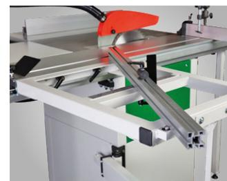
Schwenkbarer Teleskopanschlag am Formatschiebeschlitten
