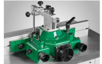
Fräsanschlag mit fein einstellbaren Aluminium-Anschlägen
