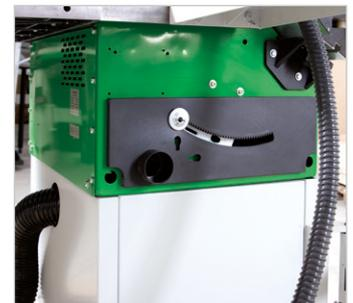
Mit zwei seitlichen Absauganschlüssen (Ø 100 mm)
