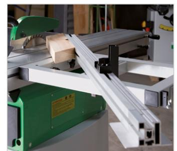
Schwenkbarer Teleskopanschlag am Formatschiebeschlitten, bis 2280 mm ausziehbar und klappbar
