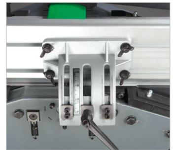
Der Aluminium-Abrichtanschlag ist um 45° stufenlos neigbar. Die eingestellte Neigung ist bequem an einer Skala ablesbar. (Abb. zeigt ADH 250)
