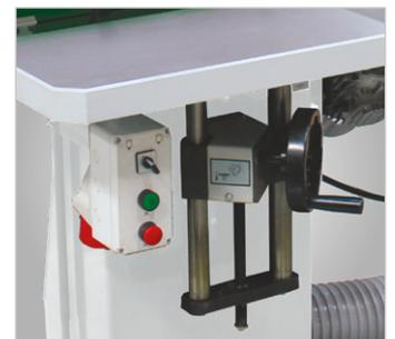
Höhenverstellbarer Schleiftisch zur Ausnutzung der gesamten Schleifbandbreite
