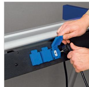
Drei integrierte 230 V Steckdosen auf der Bedienerseite
