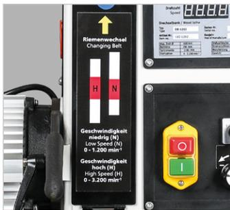
Variable Drehzahlregulierung von 0-1.200 min<sup>-1</sup> (L) und 0-3.200 min<sup>-1</sup> (H) in zwei Geschwindigkeitsstufen.
