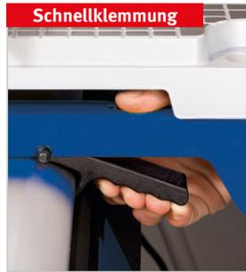
Die Halteschienen können einfach und bequem über ein Schnellklemm-System positioniert, verschoben oder abgenommen werden.
