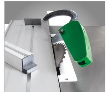
Das Sägeblatt ist bis 45° schwenkbar.
