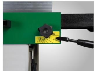
Verstellung der Spanabnahme über Bedienhebel
