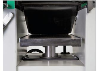
Dickentischverstellung über Handrad, Skala und numerischer Anzeige
