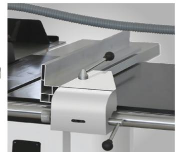
Großer Aluminium-Parallelanschlag auf Rundstangenführung mit Feineinstellung
