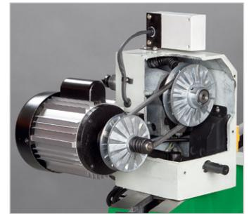
Vario Drehzahlregulierung von 500 - 2.000 min<sup>-1</sup> über Keilriemen und verstellbare Konusscheiben.
